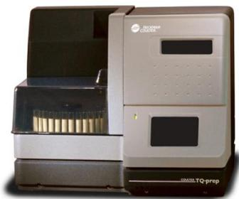
Станция пробоподготовки TQ-Prep и система реагентов IMMUNOPREP гарантируют быструю пробоподготовку образцов цельной крови по безотмывочной технологии. Автоматизация обеспечивает согласованность и воспроизводимость как между образцами, так и между лабораториями. Стандартная 32-позиционная карусель позволяет проводить обработку, при которой не требуется постоянное присутствие оператора и которая отлично дополняет проточные цитометры Beckman Coulter с автоматическими загрузчиками образцов.
